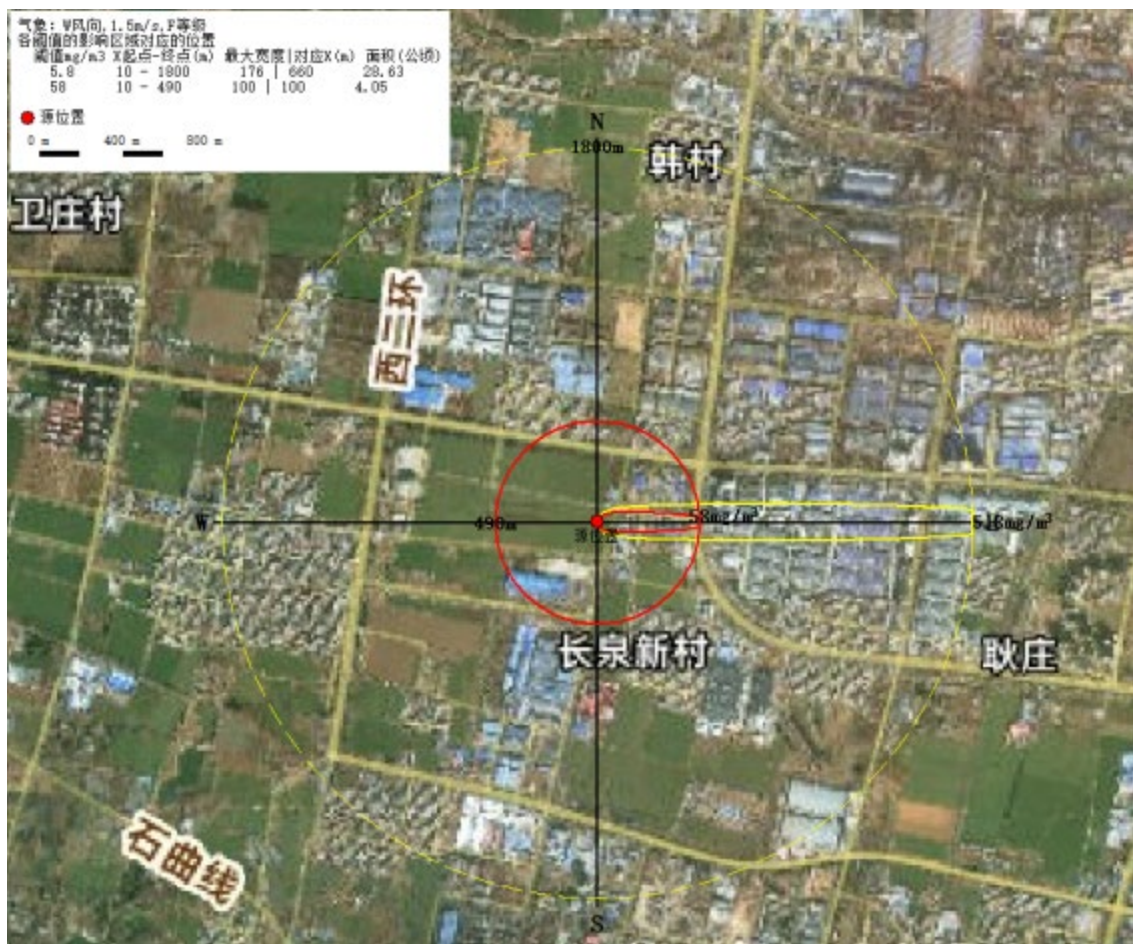
图 7-1 最不利气象液氯钢瓶管道泄漏事故影响范围图
