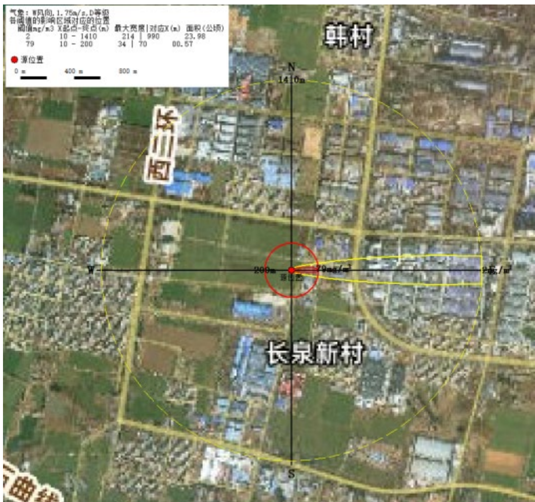
图 6-2 最常见气象液体二氧化硫钢瓶管道泄漏事故影响范围图
